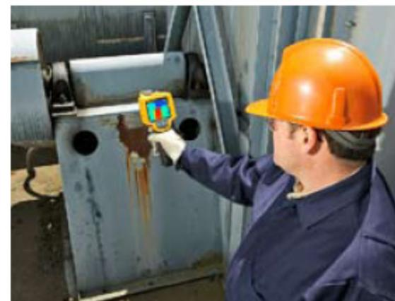
dané třemi tlačítky. Stisknutím spouště se sejme aktuální termogram, který je možné uložit na paměťovou kartu. Současně s termogramem se uloží i obraz snímané scény ve viditelném spektru, protože termokamery Ti jsou vybaveny i standardním fotoaparát. Ke každému termogramu je také možné nahrát hlasový komentář.
