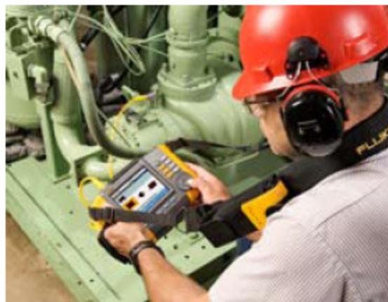
Ve druhém kroku Měření probíhá automatický sběr vibračních dat po dobu několika desítek sekund. V posledním, třetím kroku Diagnóza se na displeji přístroje zobrazí soupis zjištěných vad a stanovení jejich závažnosti ve čtyřstupňové škále.
